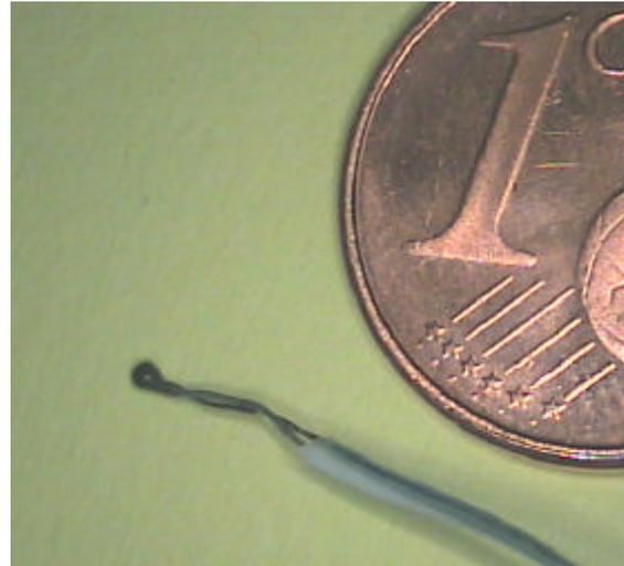
Bild 9: Messstelle eines Typ K-Thermoelementes
