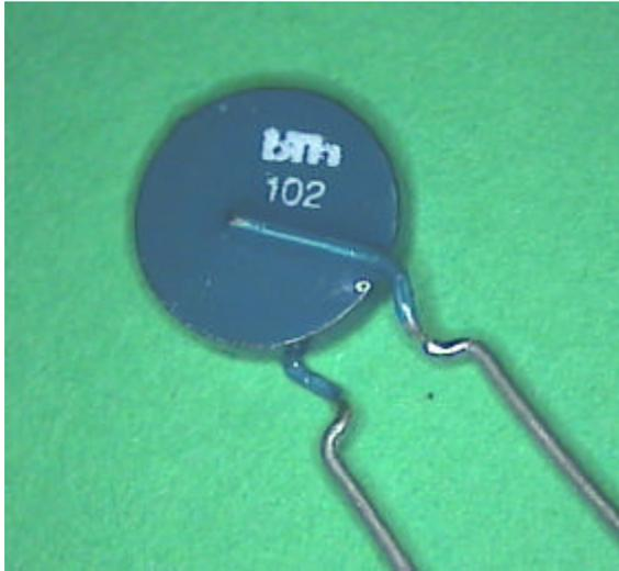
Bild 8: Bauform eines NTC-Sensors
